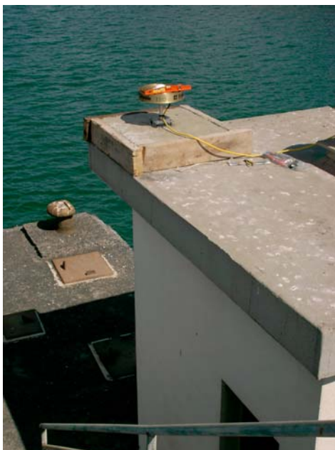
a) Monumentación: antena en el tejado de la caseta
