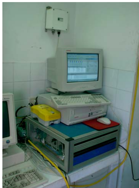
b) Sistema de adquisición GPS ( receptor y PC) y del nivel del mar ( datalogger).
